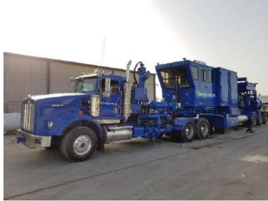
Unidade própria de Fraturamento Hidráulico da PetroReconcavo
